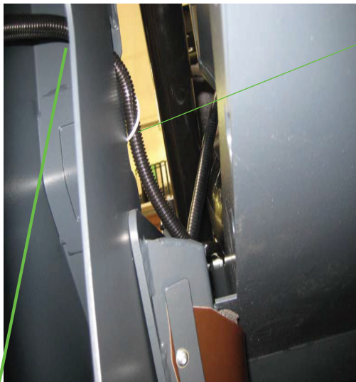
Zuleitung zu Schlusslicht/ Fahrtrichtungsanzeigern links Kabel mit Kabelbinder fixieren
